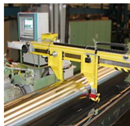
links: Erster Versuchslauf des neu entwickelten Walzenmessgerätes bei der KMF in Böbingen. oben: Erste Messungen an der geschliffenen Walze beim Kunden.
