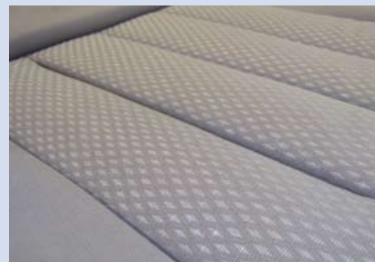
oben: Schaumstreifen auf den Füllhülsen unten: Fertig konfektionierter, mit Schaumstreifen befüllter Sitzbezug.
